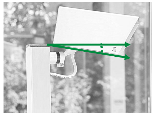
Abbildung 4: Ausrichten des Lesers, Darstellung des Neigungswinkels
