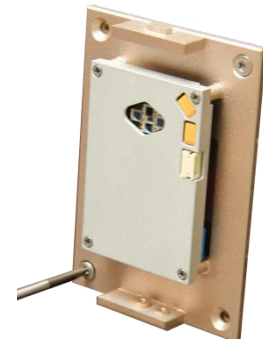
Abbildung 8: Montage der Rückwand
